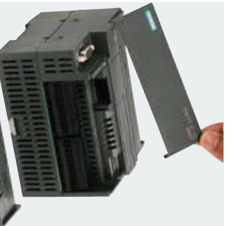
卸掉端子盖板
